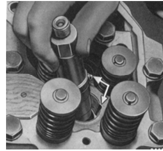
فارسونکا با پین خاری و شیار در سر سیلندر
